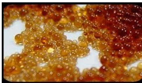
L'Amberlyst 15™ se présente sous la forme de billes de diamètre voisin de 0,6-0,85 mm.
