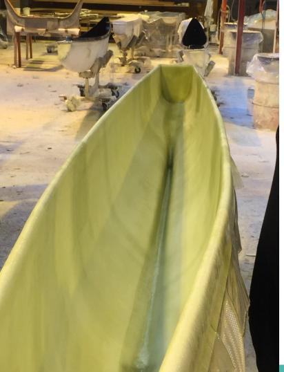
La résine est disposée sur les planches, elle même est par la suite recouverte d'une mousse qui offre des propriétés avantageuses : résistance accrue et poids de la coque nettement réduit.
