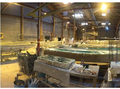
• fabrication des coques mises sous vide pour éviter les bulles d'air
