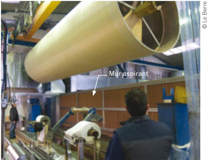
**Photo 1. Maintenance du moule dans la cabine à ventilation horizontale**
