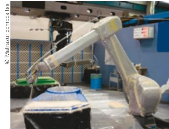
Photo 1. Application simultanée (résine et fibre) par un robot
