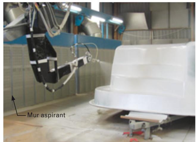
Photo 2. Pulvérisation de la résine par un robot
