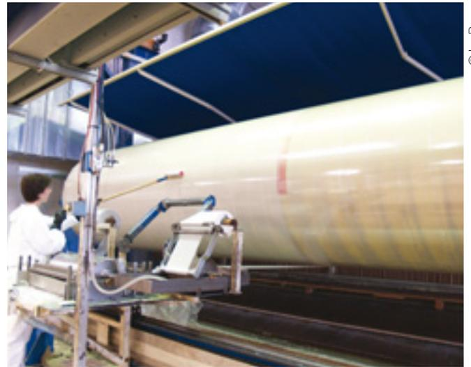
**Photo 2. Enroulement du fil imprégné puis ébullage dans la cabine à ventilation horizontale**
