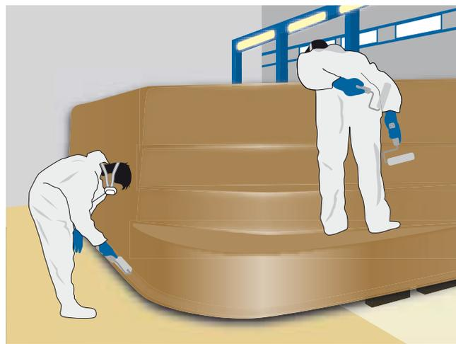
**Figure 1.** Opération d'ébullage dans la cabine à ventilation horizontale
