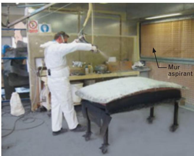
Photo 1. Cabine ouverte à flux horizontal
