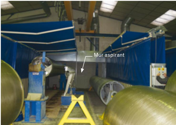
**Photo 3. Cabine de séchage à ventilation horizontale**
