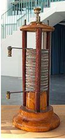
Le 20 mars 1800, Alessandro Volta, physicien italien, publie dans une lettre une découverte décisive : il vient de réaliser le premier générateur électrochimique de tension continue, qu'il baptise « la pile ». Pour cela il a utilisé des disques de cuivre et des disques de zinc séparés par de la feutrine imbibée de saumure (ou solution aqueuse de chlorure de sodium (de formule  $\text{Na}^+(\text{aq}) + \text{Cl}^-(\text{aq})$ ).
