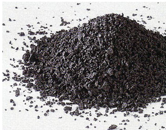
Fig. 3.2 : Charbon actif ( http://www.wehrle-umwelt.com/installations-d-adsorption )
