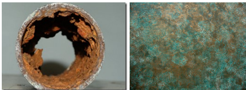
Fig. 4.4 : Métaux oxydés. Tuyau en acier rouillé à gauche. Cuivre « vert-de-gris » à droite.
