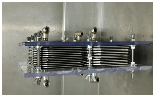
Figure 2 : Construction de la cellule sèche
