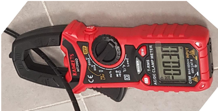
Figure 8 : Appareils de mesures d'intensité, de tension et de température
